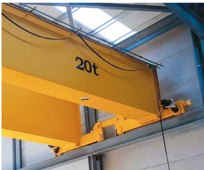
双端梁起重机（八个行走轮）
