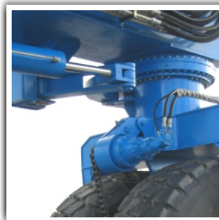
ALINEACIÓN AUTOMÁTICA DE DIRECCIÓN
