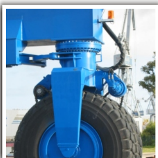
DIRECCIÓN ROBUSTA PROPORCIONAL AL RADIO DE GIRO
