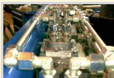
Distributeurs hydrauliques avec soupapes de sécurité
