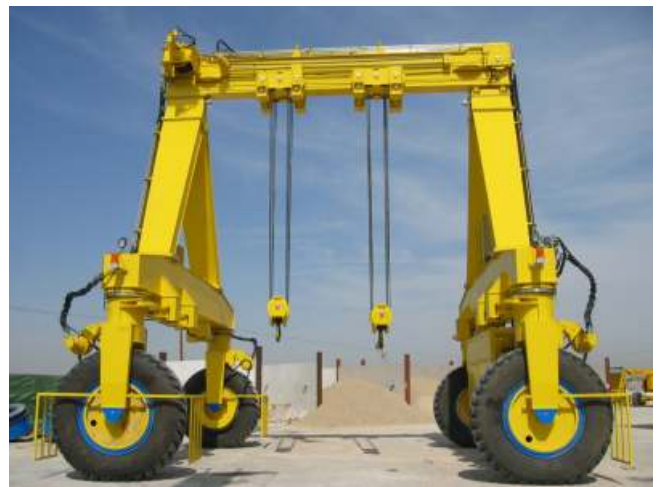
MANUTENTION DE TÊTE D'ÉOLIENNE
