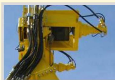
Moteurs hydrauliques de levage et déplacement chariot, indépendants pour chaque fonction
