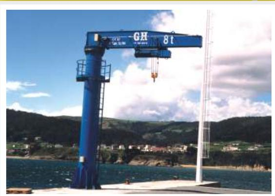
LA ESTANDARIZACIÓN DE LOS MECANISMOS A TRAVÉS DE UNA CONSTRUCCIÓN SENCILLA Y MODULAR, PERMITE CREAR UNA AMPLIA Y VARIADA GAMA DE GRÚAS DE BRAZO GIRATORIO, QUE VA DE 4 A 20 TN. CON UNA AMPLITUD DE BRAZO MÁXIMA DE 7 M. UNA CARACTERÍSTICA COMÚN EN TODAS ELLAS ES SU SENCILLEZ DE USO Y FÁCIL MANIOBRABILIDAD
