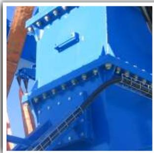
ESTRUCTURA ATORNILLADA FÁCILMENTE DESMONTABLE
